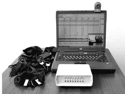
Рис. 4. Автоматический компьютерный полиграф.
